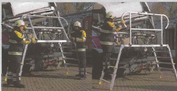
7 De leuning wordt opgeklapt (kan ook aan de andere zijde worden geplaatst).
